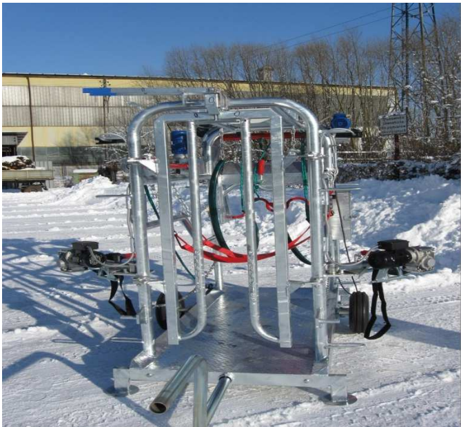
sich selbst schließende Vordertür und ein Satz von gepumpten Rädern und einer Achse und Deichsel zum manuellen Transport innerhalb der Haushalt
