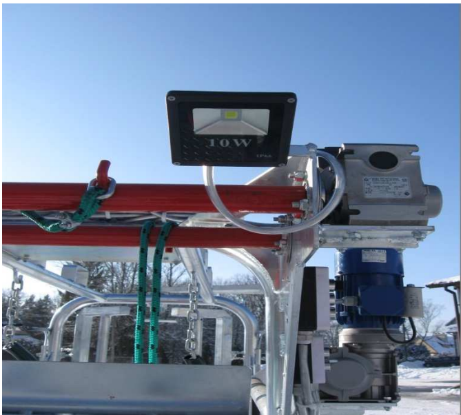
Vorder- und Hinterbeleuchtung zur Verbesserung der Arbeitsbedingungen
