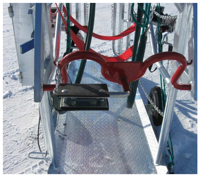
Das elektrische Hochheben der Hinterbeine mit einem nach links und rechts drehbaren Gummiuntersatz an der Kette, die die Anpassung an Klauen ermöglicht
