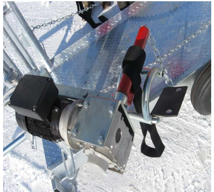
das elektrische Hochheben der Vorderbeine mit einem Gummiuntersatz an der Kette, die die Anpassung an Klauen ermöglicht
