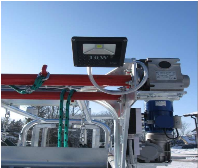
Przednie i tylne oświetlenie poprawiające warunki pracy
