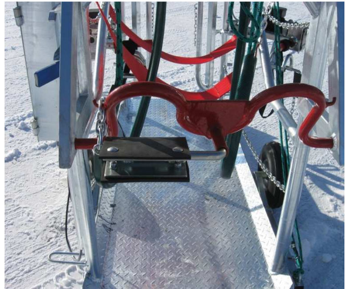
Elektryczne podnoszenie tylnych nóg z podpórką obracalną na lewą i prawą stronę z łańcuszkiem umożliwiającym dopasowanie do racic
