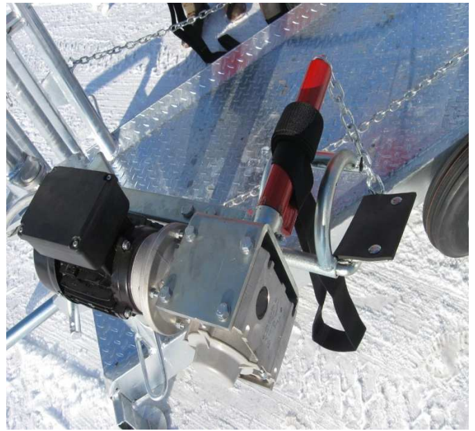
Podnoszenie elektryczne przednich nóg z gumową podpórką z łańcuszkiem umożliwiającym dopasowanie do racic
