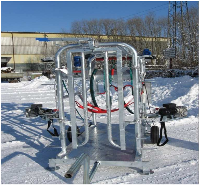
Samozatraskowa bramka przednia i zestaw pompowanych kół, ośka i dyszel do transportu ręcznego w obrębie gospodarstwa
